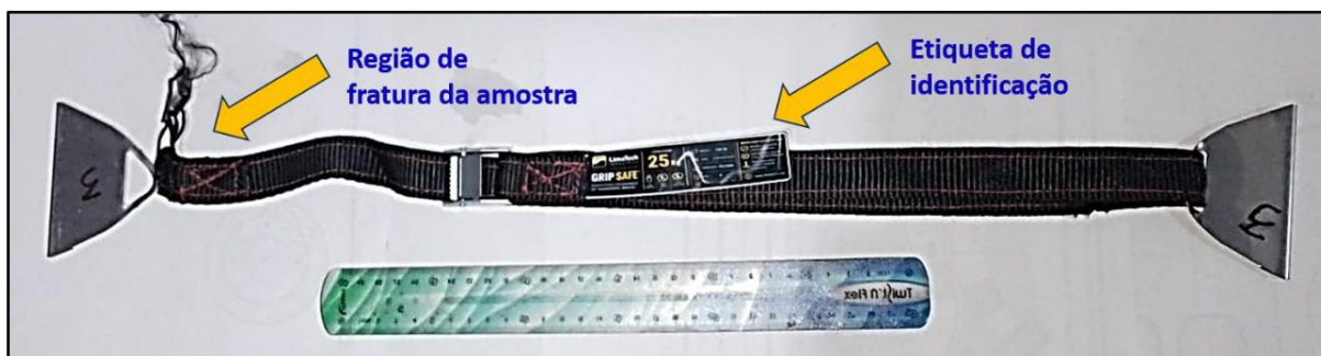
Figura 2 - Amostra da GRIP SAFE após ensaio de tração, evidenciando a região de ruptura.
